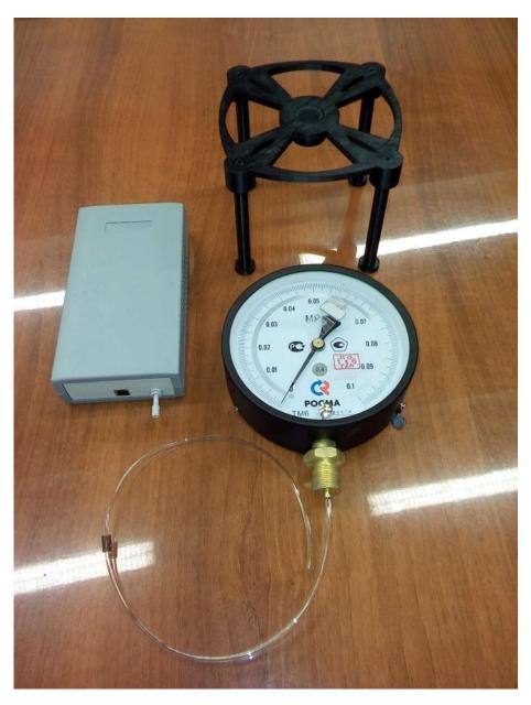
Вставьте прозрачную трубочку для калибровки (из принадлежностей для калибровки прибора) более толстым диаметром (4 мм) снизу в отверстие манометра, которое предварительно
