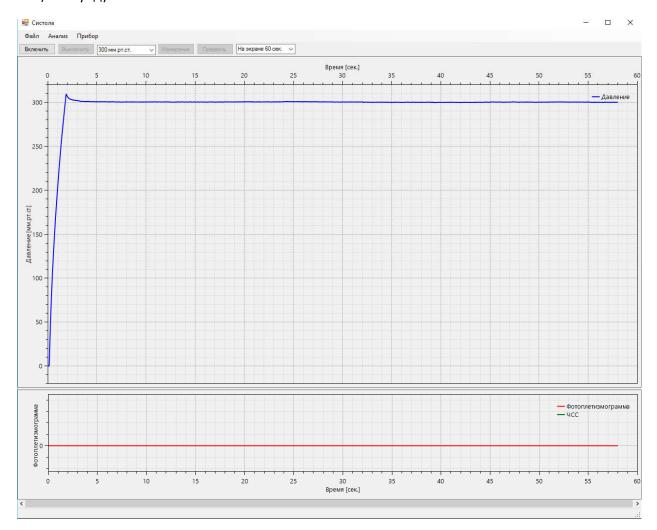
Если это не так – убедитесь, что вставили заглушку сзади прибора и проверьте что вставили трубку до конца в манометр и в прибор.
