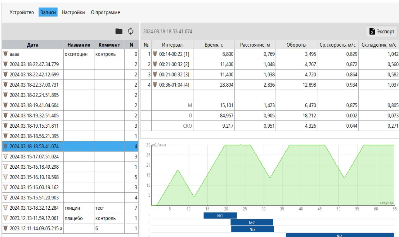
При выборе нескольких экспериментов в таблице отображается сводная таблица по выбранным экспериментами. При экспорте этой сводной таблицы в табличный файл, все выбранные эксперименты также экспортируются (в отдельные листы для формата XLSX или ниже сводной таблицы для формата CSV).
